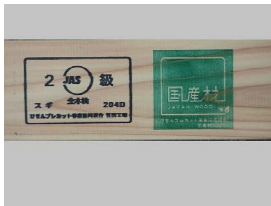
「気仙スギ」を利用した全たて枠材に、オリジナル国産材マークを刻印
