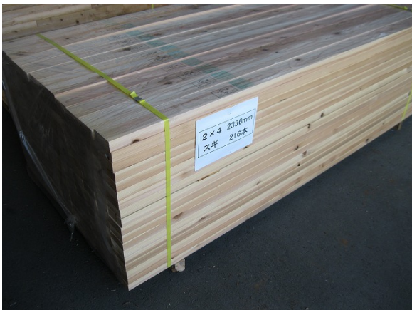
〈当社工事現場用〉「気仙スギ」利用の2×4搬入状況
