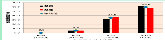
JAS規格の強度等級区分別出現頻度分布 岩手県林業技術センターwebサイト 研究成果速報 平成28年6月6日資料
