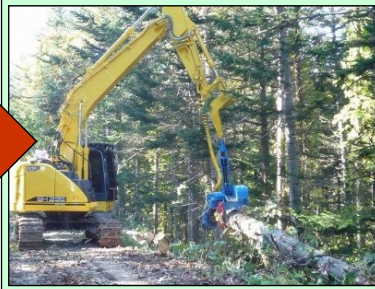
機械の大型化 例) 後端旋回半径が小さい超小機
