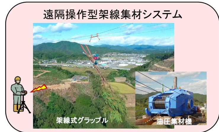
遠隔操作型架線集材システム
