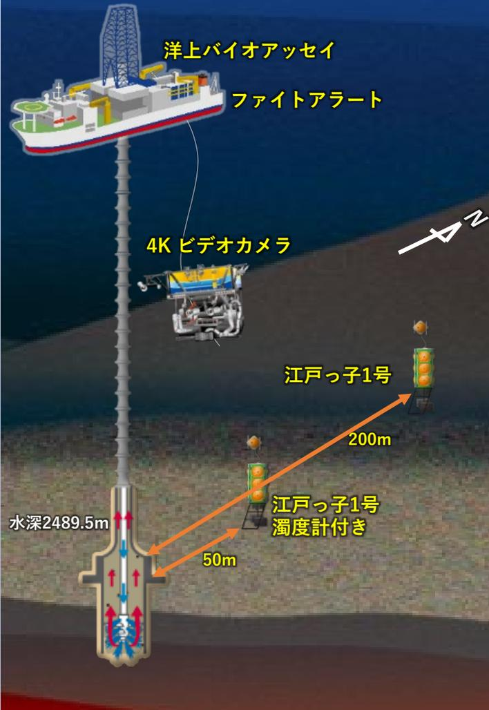
2022年8月の茨城沖での解泥・揚泥試験において、2021-2022年に発行されたISO規格を利用した環境モニタリング手法を、実際の採掘作業を想定して試験実施
