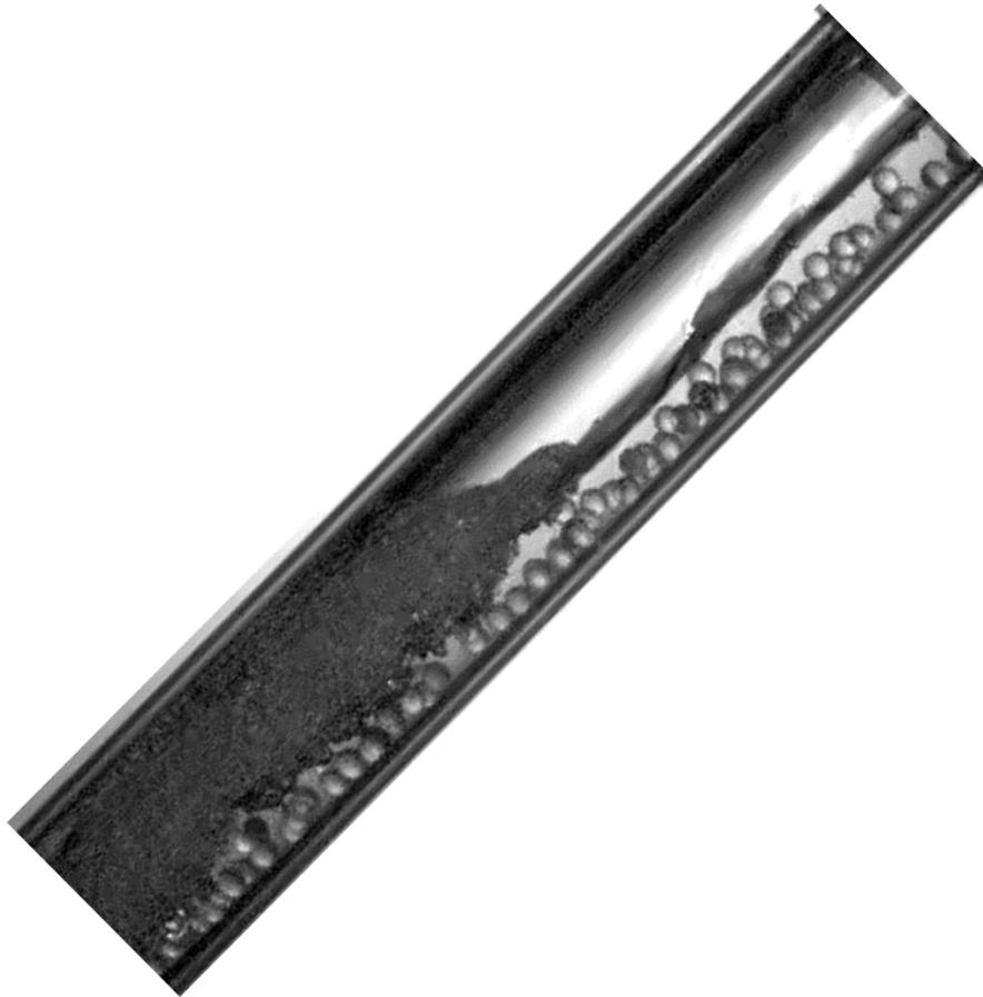
➤ 配管が傾くと、断面方向の分布が変化することを確認
