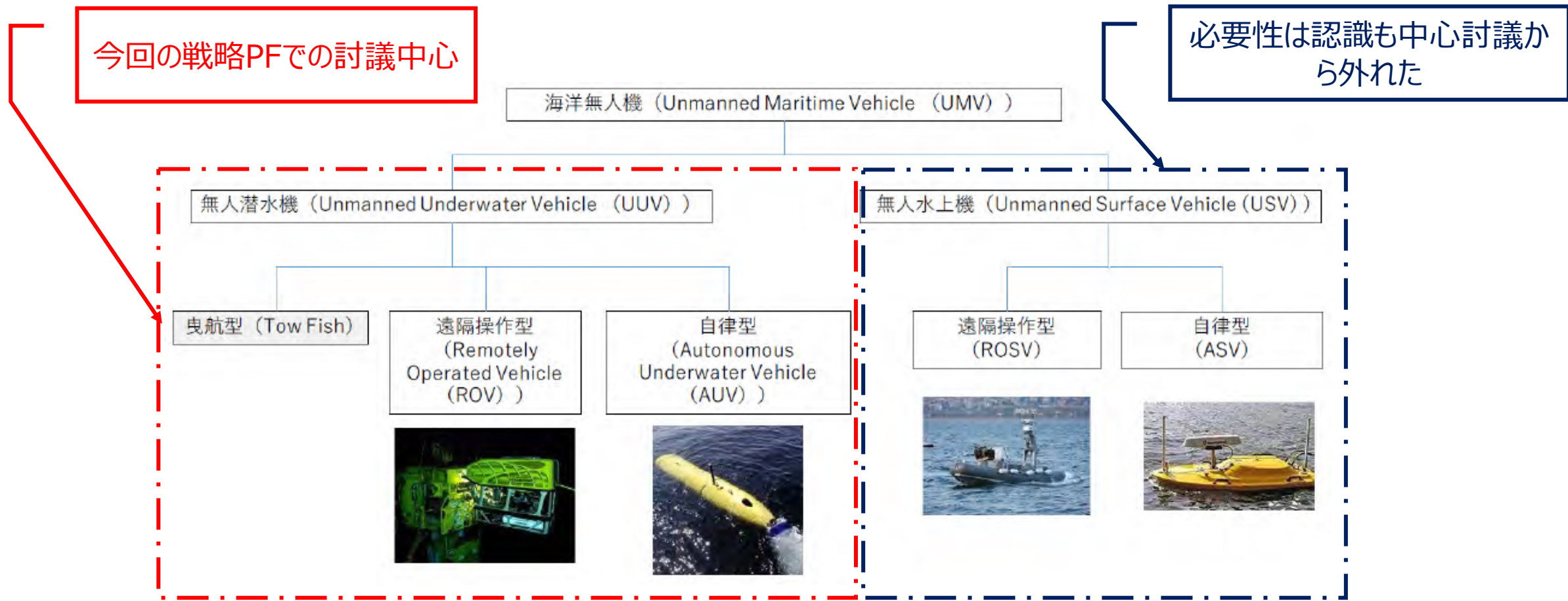
図1：AUVを含む海洋ロボティクスの分類
