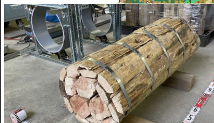
液状化対策用木質コラム【B】 (出典: 飛鳥建設ホームページ, 2026.4引用)
