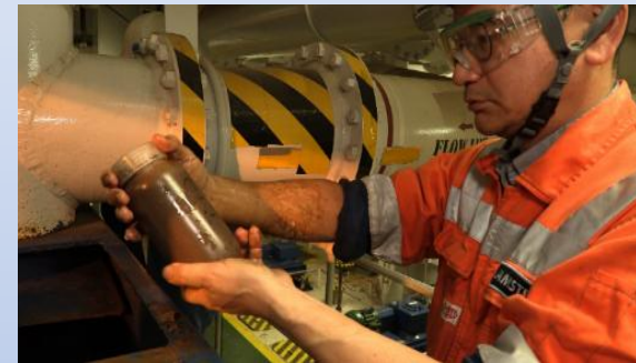
最初の揚泥サンプリング（2月1日未明「ちきゅう」船上） * 研究員は放射能や有害物質が殆ど検出されないので 素手にてサンプル採鉱中
